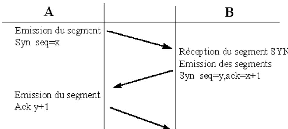
L'établissement de la connexion TCP entre deux stations A et B se fait en trois temps.
