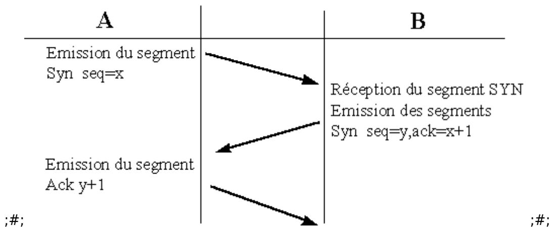
L'établissement de la connexion TCP entre deux stations A et B se fait en trois temps.
